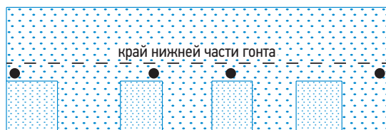
Уклон кровли менее 60°
