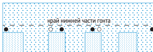
Уклон кровли более 60°
